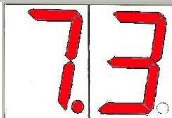
**F** Pendant le fonctionnement, la valeur de pH lu sera visible sur le Display. Le fonctionnement de la pompe est proportionnel, avec un système de pause-activité en secondes.
